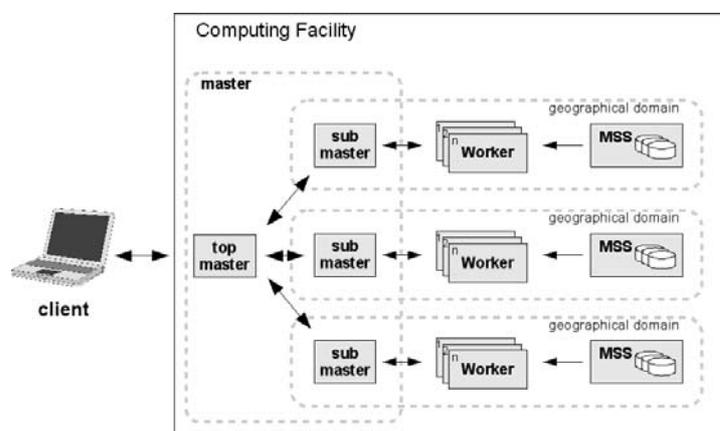
Рис. 1. Многоуровневая архитектура, заложенная в основу PROOF
