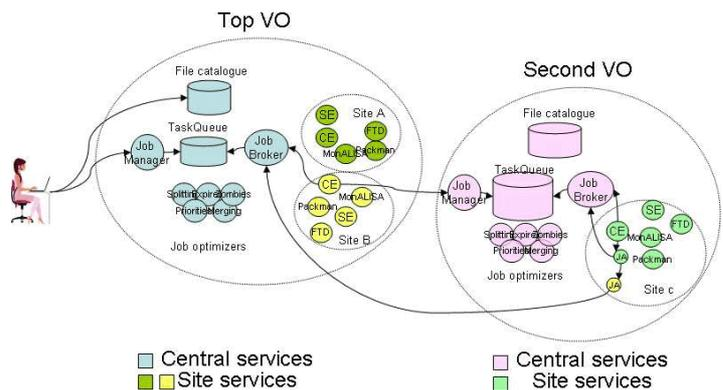
Рис. 3. Интерфейс между разными виртуальными организациями, использующими AliEn
