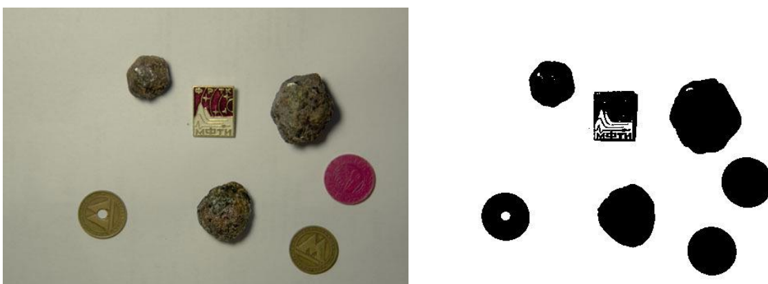
Рисунок 1.3 – Демонстрація бінарізації за порогом. [3]
