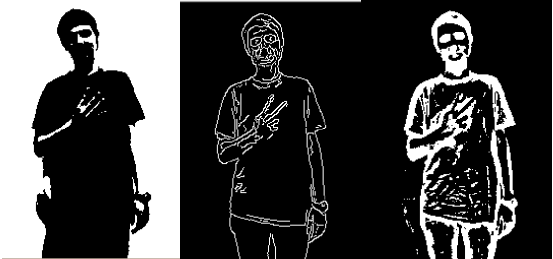
Рисунок 2.2 – результати: а) порогової фільтрації; б) аналізу контурів; с) адаптивної фільтрації.
