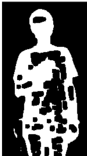
Рисунок 2.3 Результат адаптивної фільтрації після морфологічних операцій
